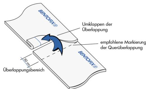
Abb. 5: Umklappen der Überlappung
