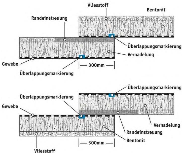
Abb. 4: Schematischer Längsüberlappungsbereich bei einer Kanteneinstreuung (oberes Bild – Vliesstoffseite oben, unteres Bild – Gewebeseite oben)
