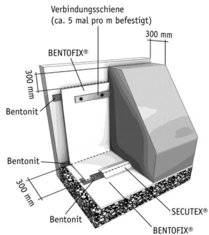
Abb. 3: Anschluss an aufgehende Bauteile
