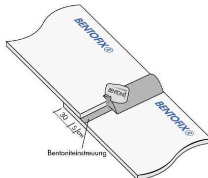
Abb. 7: Bentoniteinstreuung im Kantenbereich
