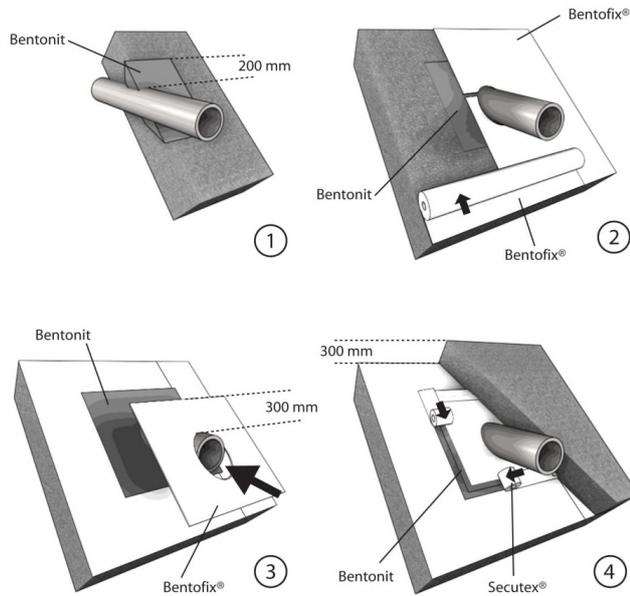
Abb. 2: Ausführung von Rohrdurchdringungen
