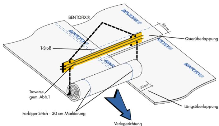
Abb. 3: Bentofix Verlegung (T-Stoß)
