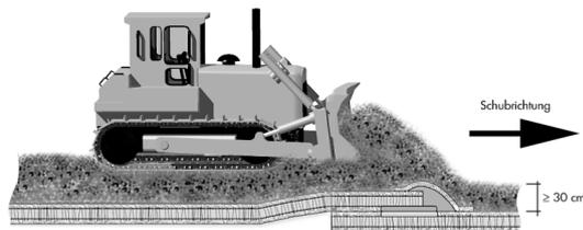
Abb. 13: Bodeneinbau und -verteilung
