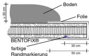
Abb. 14: Baufolienabdeckung
