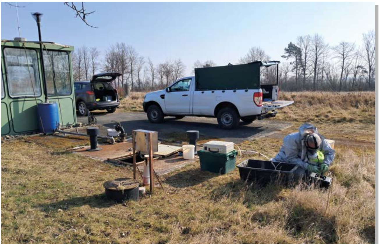
Probenahme Sickerwasser SDH
