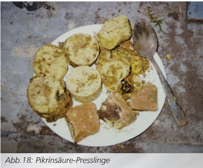
Abb. 18: Pikrinsäure-Presslinge
