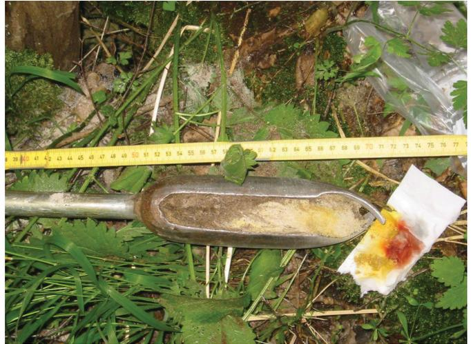
Abb. 23: Sehr deutlich positive Janowsky-Reaktion mit Mischkontamination aus Hexyl, Tetryl und Pikrinsäure
