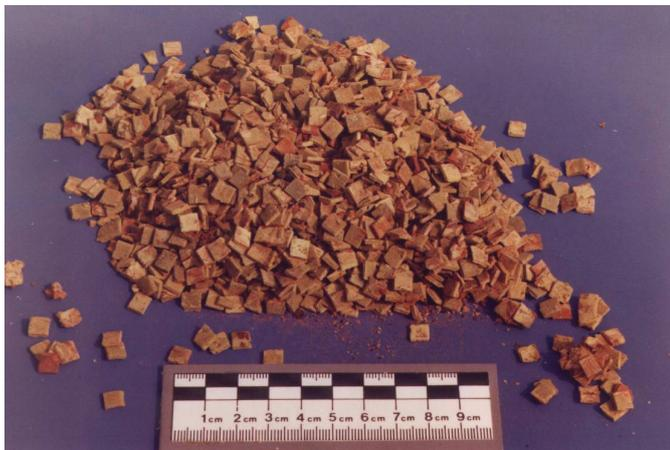
Abb. 7: A-Pulver (Nitrocellulose + Adamsit)
