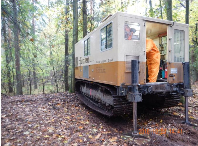
Das eingesetzte Drucksondiergerät
