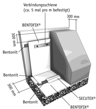
Abb. 3: Anschluss an aufgehende Bauteile
