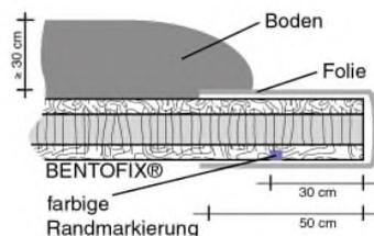
Abb. 14: Baufolienabdeckung
