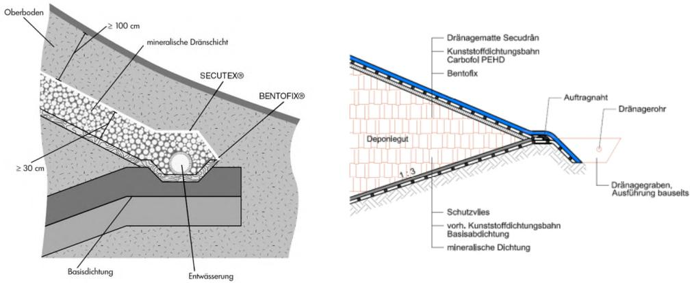
Abb. 10: Anbindung an Basisdichtung
