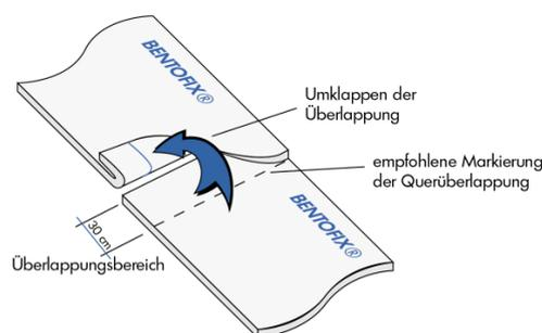
Abb. 5: Umklappen der Überlappung
