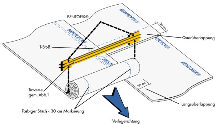
Abb. 3: Bentofix Verlegung (T-Stoß)
