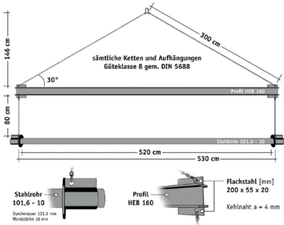
Abb. 2: Traverse geeignet für Rollengewichte bis 1.250 kg
