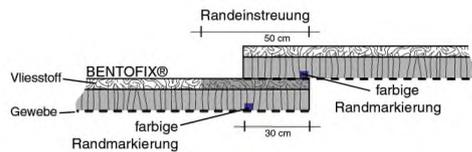
Abb. 4: Schematischer Längsüberlappungsbereich bei einer Kanteneinstreung
