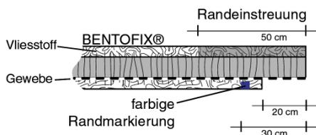
Abb. 1: Schematischer Querschnitt von Bentofix B 4000
