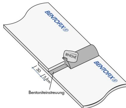
Abb. 7: Bentoniteinstreuung im Kantenbereich
