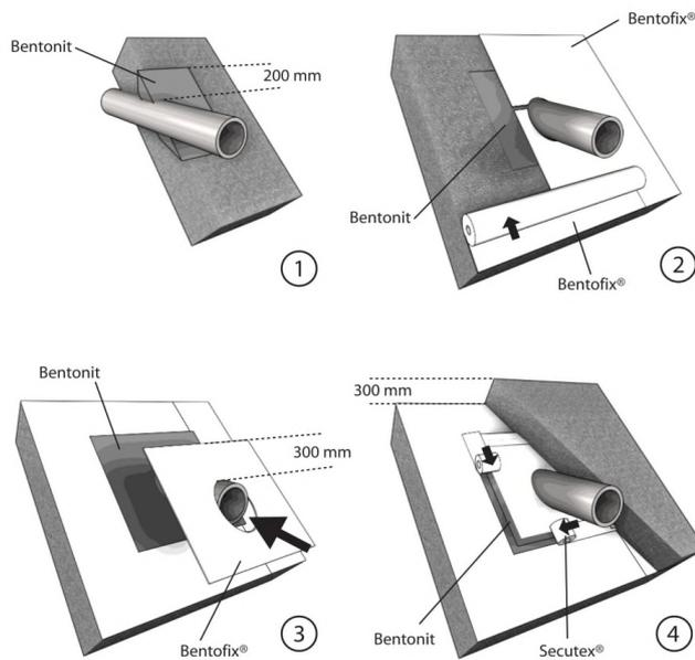
Abb. 2: Ausführung von Rohrdurchdringungen
