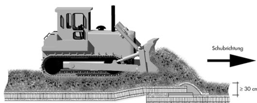
Abb. 13: Bodeneinbau und -verteilung
