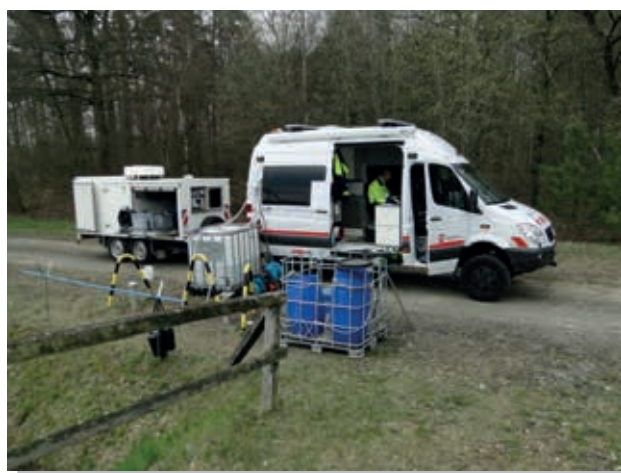
Abb. 5: Messfahrzeug mit Anhänger bei der Probenahme auf einer gesicherten Altlast mit Auffangbehältern für abgepumptes Wasser
